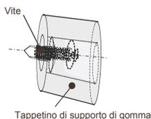
3. Allineare la vite al foro nella copertura della base inferiore. Fissare il tappetino di supporto di gomma alla copertura della base fermamente con un cacciavite a croce (non in dotazione).
