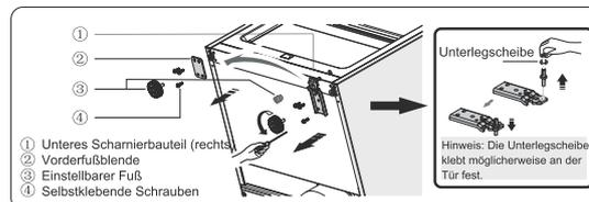
7. Schrauben Sie das untere Scharnier ab, stecken Sie es in das nächste Loch, schrauben Sie es anschließend fest und bringen Sie die Unterlegscheibe an.
