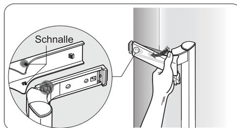
**Hinweis 2:** Montieren Sie die Griffabdeckung wie unten abgebildet: Bringen Sie zuerst die Schnalle und anschließend die Abdeckung von innen an, bis diese hörbar einrastet.
