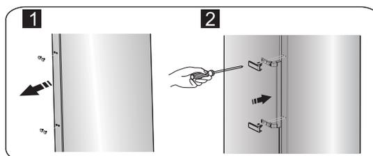
**Hinweis:** Montieren Sie die Griffabdeckung wie unten abgebildet: Bringen Sie zuerst die Schnalle und anschließend die Abdeckung von innen an, bis diese hörbar einrastet.
