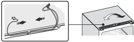
10. Bringen Sie die Tür in die entsprechende Position, richten Sie das Bauteil ① (in der Plastiktüte), und die Tür aus. Verlegen Sie das Anschlusskabel ② in der Tür von rechts nach links und befestigen anschließend das Bauteil ① und das Kabel ② mithilfe der Schrauben ③. (Bitte halten Sie die Tür während der Montage fest)
