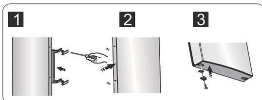
**Hinweis 1:** Entfernen Sie die Griffabdeckung wie unten abgebildet: Biegen Sie den oberen Flügel und nehmen Sie die obere Schnalle vom Griff. Wiederholen Sie diesen Vorgang auf der anderen Seite. Nehmen Sie anschließend die Griffabdeckung ab.
