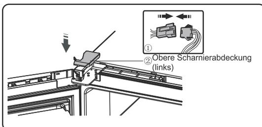
12. Drehen Sie das Bauteil ① um 180° und montieren Sie auf die rechte Ecke der Tür. Montieren Sie anschließend das Bauteil ② (beide Bauteile werden in Schritt 2 abgenommen).
