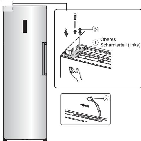
11. Schließen Sie die elektrische Steckverbindung ① gemäß Schritt 3 an und installieren Sie das Teil ② (in der Plastiktüte).
