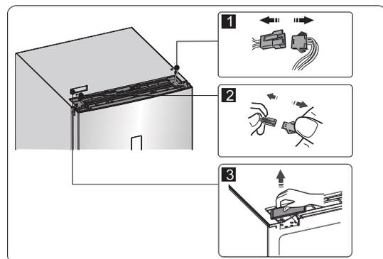
4. Entfernen Sie die Schrauben ①, lösen Sie das Kabel ② und entfernen Sie das Bauteil ③.
