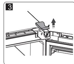
3. Ziehen Sie den elektrischen Anschluss ① sowie den elektrischen Anschluss ② und nehmen Sie das Bauteil ③ ab.
