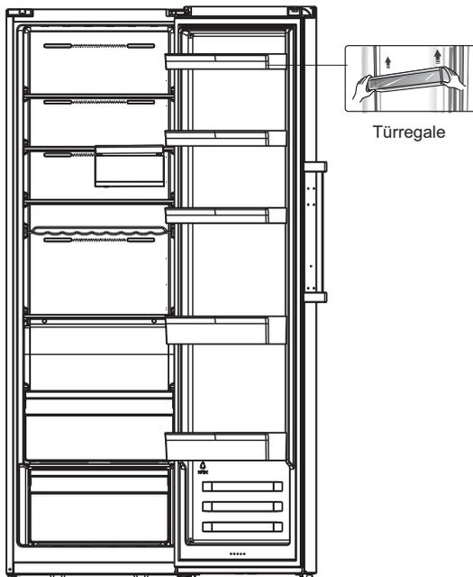
2. Öffnen Sie das Bauteil ① an der Oberseite des Kühlschranks von rechts und nehmen Sie das Bauteil ③ und ④ an der Tür auf die gleiche Weise ab. Nehmen Sie das Bauteil ② ab und stecken Sie es zurück in den Plastikbeutel.
