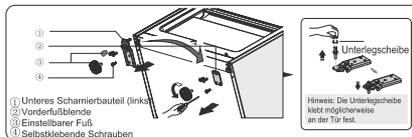
7. Schrauben Sie das untere Scharnier ab, stecken Sie es in das nächste Loch, schrauben Sie es anschließend fest und bringen Sie die Unterlegscheibe an.
