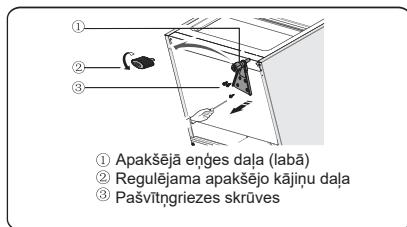
11. Nomainiet apakšējo enģes daļu uz kreiso pusī un piestipriniet to ar pašvītgriezes skrūvēm. Nomainiet priekšējo kājiņu plātni uz otru pusī un nostipriniet to ar ar pašvītgriezes skrūvēm. Uzstādiet regulējamo apakšējo kājiņu daļas.
