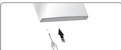
7. Keerake lahti kaks isekeermestavat kruvi, millega on kinnitatud keskmine hing, seejärel eemaldage keskmine hing, mis hojab paigal alumist ust.
