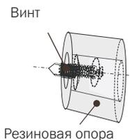
3. Вставьте винт в отверстие в крышке двери. Прикрутите резиновую опору к двери с помощью крестовой отвертки (не поставляется в комплекте).
