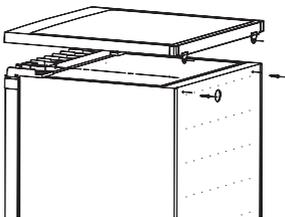
2. Открутите четыре винта, как показано на рисунке. Снимите верхний шарнир и отложите в надежное место.
