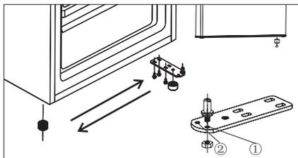
4. Установите дверь на другую сторону и проверьте, чтобы стержень вошел во втулку в нижней крышке двери (отверстие). Вставьте верхний шарнир в отверстие на двери и закрепите двумя винтами. Прикрутите два винта на другую сторону.
