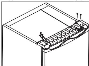
5. Установите верхнюю крышку и прикрутите двумя винтами в задней части.
