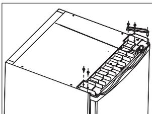
3. Аккуратно снимите дверцу и положите на мягкую поверхность, чтобы дверца не поцарапалась. Открутите обе регулируемые ножки и снимите нижнюю скобу шарнира, открутив винты. Переставьте на другую сторону.
