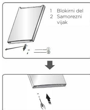
9. Prestavite pokrove (oz. čepe) odprtin za vijke na čelni stranici predelne stene med hladilnim in zamrzovalnim delom z leve na desno stran (kot kaže spodnja slika).
