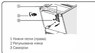
11. Помістіть нижню петлю зліва та зафіксуйте її за допомогою спеціальних саморізів із фланцем. Помістіть панель передніх ніжок з іншого боку та зафіксуйте її за допомогою спеціальних саморізів із фланцем. Установіть регульовані ніжки.
