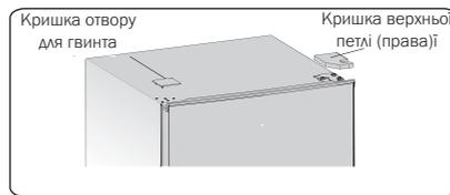
3. За допомогою торцевого або ріжкового ключа 8 мм викрутіть спеціальні саморізи з фланцем, які кріплять праву верхню петлю (підтримуйте верхні дверцята рукою під час цього).
