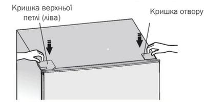
17. Відкрийте верхні дверцята й установіть дверні полицки, потім закрийте дверцята. Попередження! Під час змінення сторони відкриття дверцят прилад повинен бути відключений від електромережі. Заздалегідь вийміть штепсель із розетки.
