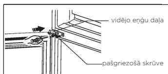
14. Pārlieci augšējās durvis atbilstošā pozīcijā. Nodrošiniet, lai durvis būtu pareizā augstumā un ievietojiet vidējās eņģes asi augšējo durvju apakšējā atverē.
