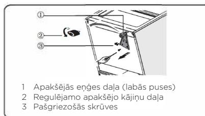
11. Nomainiet apakšējo eņģu daļu un nostipriniet to ar īpašajām atlokveida pašgriezošajām skrūvēm. Pārvietojiet regulējamo apakšējo kājiņu daļas uz otru pusī un nostipriniet tās.
