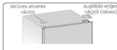
3. Ar 8 mm gala atslēgu vai uzgriežņu atslēgu atskrūvējiet īpašās atlokveida pašgriezošās skrūves, ko izmanto labās augšējās eņģes daļas piestiprināšanai (skrūvēšanas laikā atbalstiet augšējās durvis ar roku).
