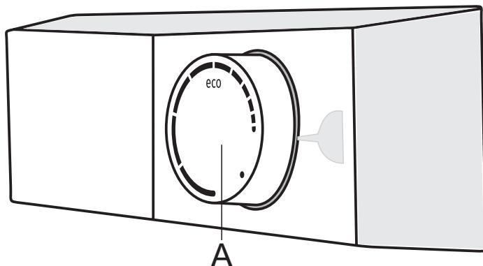
**A Temperatūras iestatīšana un ieslēgšanas/izslēgšanas poga.**
