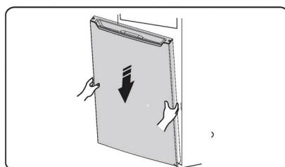
13. Pagrieziet vidējās eņģes daļu par 180 grādiem, pārlieci to un noregulējiet tās pozīciju, ievietojiet vidējās eņģes asi apakšējo durvju augšējā atverē, pievelciet bultskrūves.
