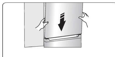
15.Pārlieciet augšējo eņģu daļu, ievietojiet augšējās eņģes asi augšējo durvju augšējā atverē un pielāgojet augšējo durvju pozīciju (pielāgošanas laikā atbalstiet augšējās durvis ar roku), nostiprinot augšējo eņģes daļu ar īpašām atlokveida pašgriezošām skrūvēm.
