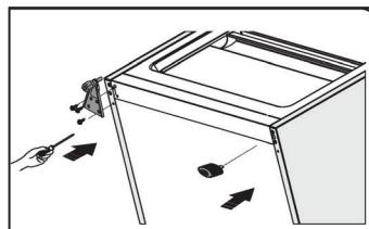
12. Pārlieci apakšējās durvis pareizajā pozīcijā, noregulējiet apakšējās eņģes daļu, ievietojiet eņģes asi apakšējo durvju apakšējā atverē un pievelciet bultskrūves.
