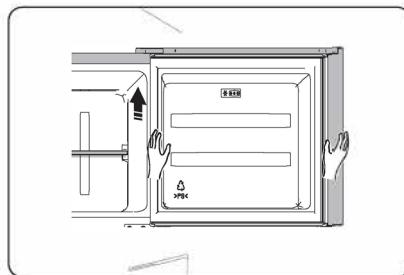
6. Novietojiet augšējās durvis uz līdzzenas virsmas ar paneli uz augšu. Atskrūvējiet skrūvi (2) un noņemiet detaļu (1), pēc tam uzstādīt tās kreisajā pusē un cieši nostipriniet.
