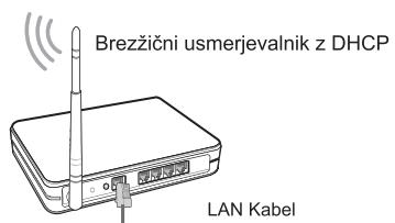
Brezžični usmerjevalnik z DHCP
