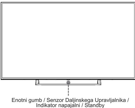
Enotni gumb / Senzor Daljinskega Upravljalnika / Indikator napajalni / Standby
