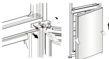
9. Zatim postavite donja vrata na glatku površinu, sa panelom gore. Otpustite vijak ③ i izvadite dio ② i dio ①, instalirajte zamjenjivi lijevi zaustavljač vrata ④ (u plastičnoj kesi) i dio ② (stop blok), sa lijeve strane sa vijkom ③. Sačuvajte dio ① aparata za kasniju uporabu.
