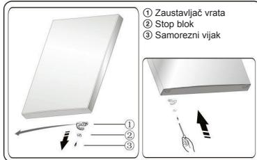
8. Otpustite vijke koje služe za učvršćenje središnje šarke i izvadite središnji pant. Zatim izvadite donja vrata.
