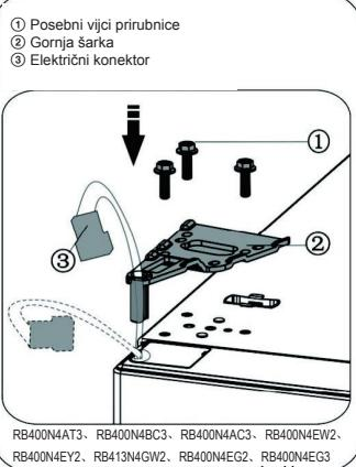
17. Povežite električni konektor ① kao što je prikazano na slici, zatim pričvrstite dio ② vijkom ③ vidi korak 2.
