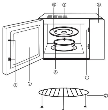
1. Bezpečnostný uzatvárací systém dverí
