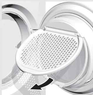
В том случае, если фильтр засорен настолько, что его необходимо вымыть, извлеките фильтр из углубления (рисунок), вымойте его под проточной водой и высушите. Следите за тем, чтобы фильтр полностью вошел в соответствующее углубление, и только после этого закройте крышку фильтра.
