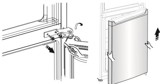
8. Coloque a porta inferior numa superfície suave com o seu painel para cima. Desaperte o parafuso ② e a parte ①, depois instale-os no lado esquerdo e aperte seguramente.
