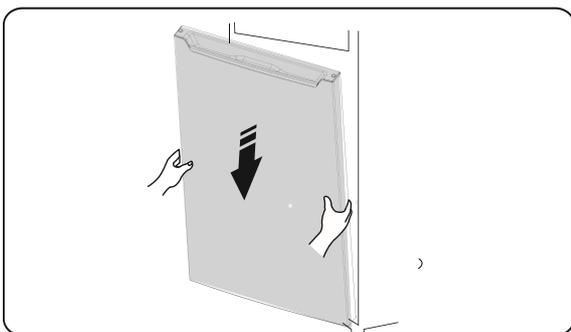
13. Vire a parte de articulação do meio a 180° graus, transfira-o e ajuste a sua posição, coloque o eixo de articulação do meio no buraco superior da porta inferior, aperte os parafusos.
