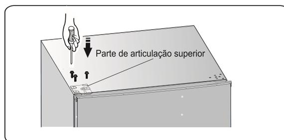
16. Instale a tampa do buraco de parafuso no canto superior direito do refrigerador. Instale a tampa articulada superior (que está no saco de plástico) no canto esquerdo. Coloque a tampa articulada superior no saco de plástico.
