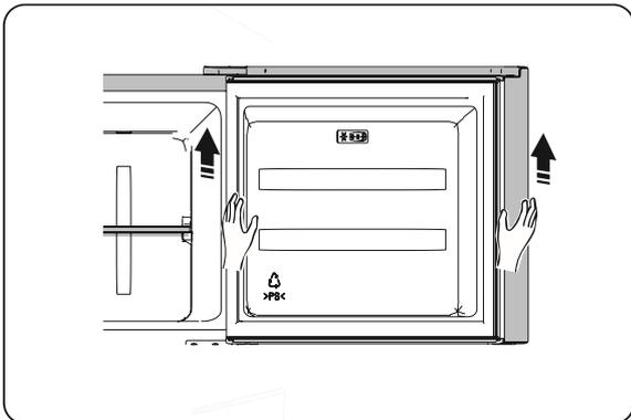
6. Coloque a porta superior numa superfície suave com o seu painel para cima. Desaperte o parafuso ② e a parte ①, depois instale-os no lado esquerdo e aperte seguramente.
