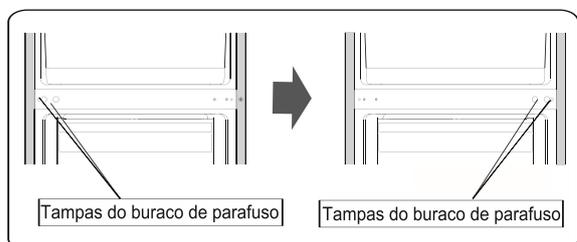
10. Deite o refrigerador numa espuma suave ou material similar. Remova as partes dos dois pés ajustáveis e baixe a parte de articulação inferior desapertando os parafusos de auto-esvaziamento flange especial.
