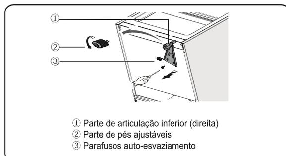
11. Substitua a parte de articulação inferior para o lado esquerdo e fixe-o com os parafusos de auto-esvaziamento flange especial. Substitua as partes dos pés ajustáveis para outro lado e fixe-os.
