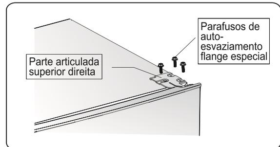
4. Retire o eixo da articulação superior, transfira-o para o lado revertido e aperte seguramente, depois coloque em lugar seguro.
