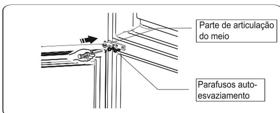
14. Transfira a porta superior para a posição apropriada. Segure o nível da porta, coloque o eixo da articulação do meio no buraco inferior da porta superior.
