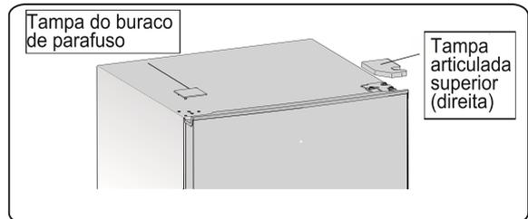
3. Desaperte os parafusos de auto-esvaziamento de flange especial que são usados para ficar a parte de tampa articulada superior direita por condutor de tomada 8mm ou chave inglesa (por favor, segure a porta superior com a sua mão quando o fizer).
