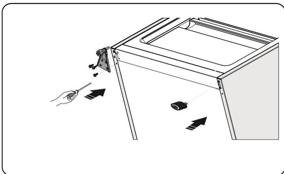
12. Transfira a porta inferior para a posição apropriada, ajuste a parte de articulação inferior, ponha o eixo da articulação no buraco inferior da porta inferior, depois aperte os parafusos.
