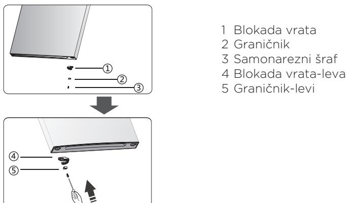
9.Koristeći imbus ključ (isporučen u plastičnoj kesici) i križni šrafciger olabavite šrafove i uklonite srednji desni šarnir. Nakon toga ponovno zatvorite vrata.
