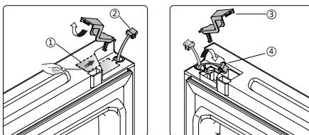
8.Otpustite šraf 3 i skinite deo br. 2 i deo br. 1. Montirajte rezervnu blokadu vrata 4 i levi graničnik 5 (priloženi su u plastičnoj kesici) na levu stranu pomoću vijka 3. Spremite deo br. 1 i deo br. 2 u blizinu aparata za buduće potrebe.
