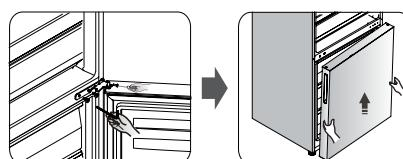
10.Stavite donja vrata na mekanu površinu, sa čelnom stranicom okrenutom nagore Otpustite šraf 3 i skinite deo br. 2 i deo br. 1. Nakon toga montirajte levu blokadu vrata 4 i levi graničnik 5 (priloženi su u plastičnoj kesici) na levu stranu, te ih čvrsti pritegnite pomoću šrafa 3.
