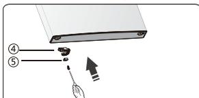
11. Die Abdeckungen der Schraubenlöcher und die Schrauben auf der mittleren Abdeckplatte von links nach rechts austauschen (siehe Abbildung unten).
