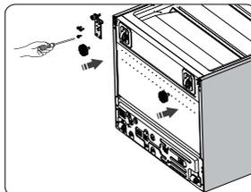
15. Stellen Sie den Kühlschrank aufrecht hin, stecken Sie die untere Tür vorsichtig auf den unteren Scharnierstift und halten Sie sie in Position. Installieren Sie das mittlere Scharnier links (im Plastikbeutel enthalten) und achten Sie darauf, dass die untere Tür gesichert ist.
