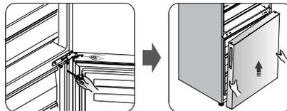
10. Legen Sie die untere Tür mit der Frontabdeckung nach oben auf eine glatte Oberfläche. Lösen Sie die Schraube 3 und nehmen Sie Teil 2 und Teil 1 ab. Bringen Sie dann den Türstopper links 4 und den Anschlagblock links 5 (im Plastikbeutel mitgeliefert) auf der linken Seite an und ziehen Sie sie mit der Schraube 3 fest an.
