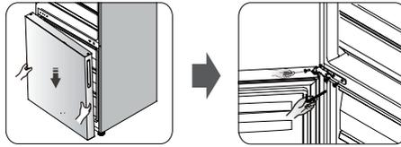
16. Bringen Sie die obere Tür in die entsprechende Position. Halten Sie die Tür gerade, führen Sie die mittlere Scharnierachse in das untere Loch der oberen Tür ein. Montieren Sie das Scharnier 2 (im Plastikbeutel mitgeliefert) mit den Schrauben 1. Halten Sie die obere Tür während der Installation mit der Hand fest.
