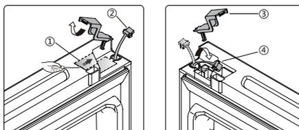
8. Lösen Sie die Schraube 3 und nehmen Sie Teil 2 und Teil 1 ab. Installieren Sie den linken Ersatztürstopper 4 und den linken Anschlagblock 5 (im Plastikbeutel enthalten) auf der linken Seite mit der Schraube 3. Bewahren Sie Teil 1 und Teil 2 für spätere Verwendung am Gerät auf.
