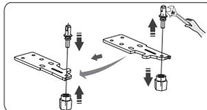
14. Ersetzen Sie das untere Scharnierteil auf der linken Seite und befestigen Sie es mit den Spezialflanschschrauben. Setzen Sie die verstellbaren Füße auf die andere Seite und befestigen Sie sie.
