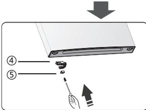
9. Verwenden Sie den Inbusschlüssel (im Plastikbeutel enthalten) und den Kreuzschraubendreher, um die Schrauben zu lösen und das rechte mittlere Scharnier zu entfernen. Entfernen Sie dann die untere Tür.
