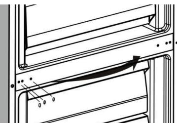
11. Наклоните холодильник назад, снимите деталь 2.
