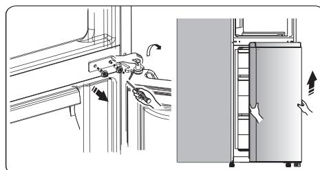
9. Положите дверь на мягкую поверхность лицевой панелью вверх. Открутите винт 3 и снимите детали 2 и 1. Установите прилагаемый левый ограничитель открывания двери 4 (в пакете) и деталь 2 (упор ограничителя) с левой стороны и закрепите с помощью винта 3. Сохраните деталь 1 для дальнейшего использования.
