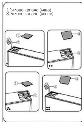
7. Развийте винт 3 и свалете част 2 и част 1. Монтирайте заместващия стопер на вратата вляво 4, предоставен (в найлоновия плик) и част 2 (блока на стопера) от лявата страна с винт 3. Пазете част 1 с уреда за бъдещо ползване.
