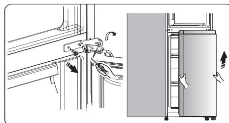
9. Поставете долната врата на гладка повърхност с панела нагоре. Развийте винт 3 и свалете част 2 и част 1. Монтирайте заместващия стопер на вратата вляво 4, предоставен (в найлоновия плик) и част 2 (блока на стопера) от лявата страна с винт 3. Пазете част 1 с уреда за бъдещо ползване.
