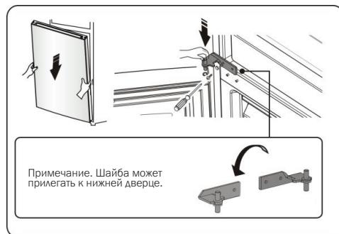
15. Установите и выровняйте верхнюю дверцу, затем прикрутите деталь 2 винтами 1. Перед тем как прикручивать деталь 2, проденьте провод коннектора 3 через отверстие шарнира 2, см. пункт 3. (Придерживайте верхнюю дверь рукой).
