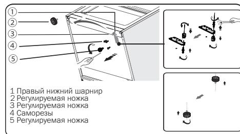
12. Снимите деталь 3 со стержня нижнего шарнира, затем открутите стержень нижнего шарнира, переставьте на другую сторону и прикрутите. Установите деталь 3 на стержень нижнего шарнира.
