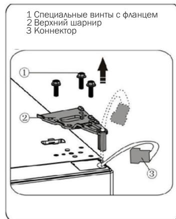
4. Приподнимите верхнюю дверцу и аккуратно снимите со среднего шарнира. Положите дверцу на мягкую поверхность, повернув лицевой панелью вверх.
