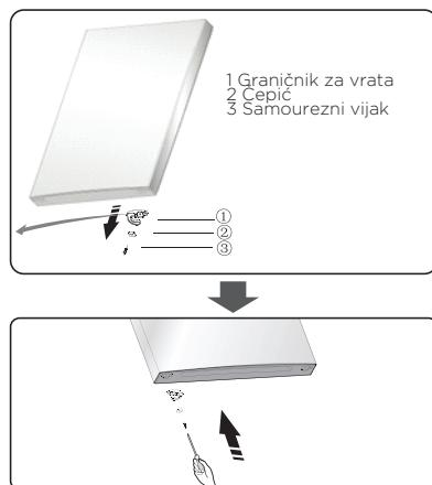
10. Premjestite kapice otvora za vijke na srednjoj pokrovnoj ploči s lijeva na desno (kao što je prikazano na slici ispod).
