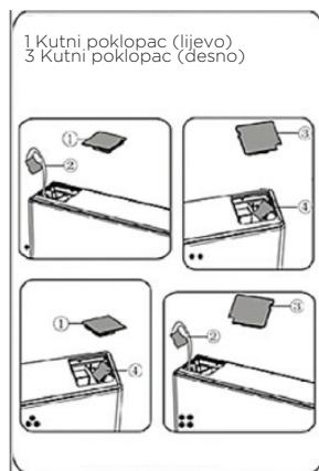
7. Otpustite vijak 3 i skinite dio 2 i dio 1, postavite zamjenski graničnik vrata-ljevo 4 isporučen (u plastičnoj vrećici) i dio 2 (čepić) na lijevu stranu vijkom 3. Držite dio 1 uz uređaj za buduću uporabu.
