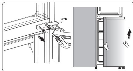
9. Postavite donja vrata na glatku površinu s pločom prema gore. Otpustite vijak 3 i skinite dio 2 i dio 1. Postavite isporučeni zamjenski graničnik vrata-lijevo 4 (u plastičnoj vrećici) i dio 2 (čepić) na lijevu stranu vijkom 3. Držite dio 1 uz uređaj za buduću uporabu.
