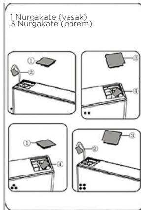
7. Keerake lahti kruvi 3 ja eemaldage osad 2 ja 1. Paigaldage vasakpoolne uksestopperi asendaja 4 (kilekotis) ja osa 2 (stopperklots) vasakule poole kruvi 3 abil. Hoidke osa 1 seadme juures, et seda tulevikus kasutada.
