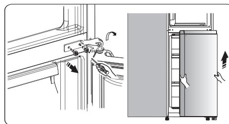
9. Asetage alumine uks siledale pinnale, paneel ülespoole. Keerake lahti kruvi 3 ja eemaldage osad 2 ja 1. Paigaldage vasakpoolne uksestopperi asendaja 4 (kilekotis) ja osa 2 (stopperklots) vasakule poole kruvi 3 abil. Hoidke osa 1 koos seadmega, et seda tulevikus kasutada.
