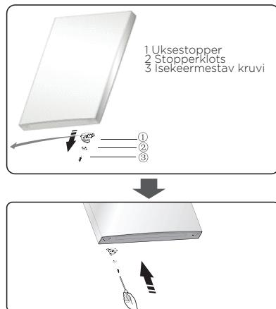
10. Vahetage keskmise katteplaadi kruviava katted vasakult paremale (nagu näidatud allpool oleval joonisel).
