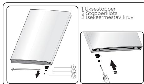
8. Keerake lahti kruvid , mida kasutatakse keskmise hinge kinnitamiseks ja eemaldage keskmine hing . Seejärel eemaldage alumine uks.
