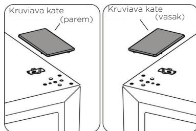
6. Eemaldage osa 1 ülemise katte vasakust ülemisest servast. Seejärel eemaldage osa 3 ülemise katte ülemisest paremast servast. Paigaldage ülemisekatte parema ülemise serva osa 1.
