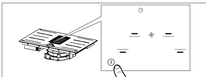
Pritisnite in 2 sekundi držite tipko za vklop/izklop , da vklopite in aktivirate funkcije plošče. Vis indikatorji kažejo
