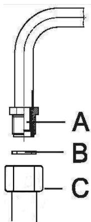
**Après avoir raccordé l'appareil au gaz, vérifiez l'étanchéité de tous les raccords.**
