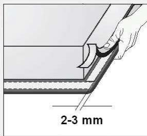
Avant d'insérer l'appareil dans la découpe du plan de travail, il est indispensable de poser sur la face inférieure de la table de cuisson en vitrocéramique ou en verre le joint en mousse fourni (voir la figure).
