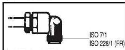
• Lors du raccordement, maintenez fermement le raccord coudé R1/2 pour l'empêcher de tourner.
