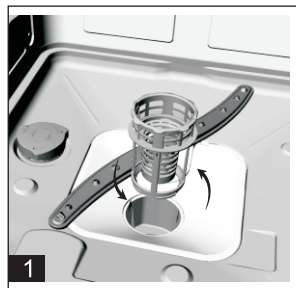
Schritt 1: Den Grobfilter kontrarotieren und dann anheben.
