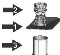
Filhačný systém pozostáva z hrubého filtra, plochého (hlavného) filtra a mikrofiltra (jemného filtra).
