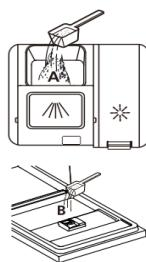
3: Zavorte uzáver posunutím dopredu a následným zatlačením.
