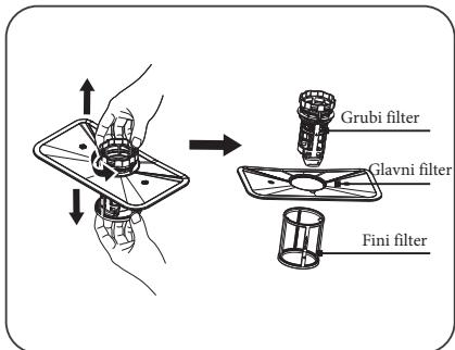
Filterski sistem sastavljen je iz grubog filtera, ravnog (glavnog) filtera, i mikro filtera (fini filter).
