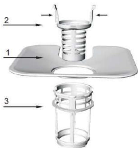
Le système de filtration comprend un filtre grossier, un filtre plat (filtre principal) et un microfiltre (filtre fin).
