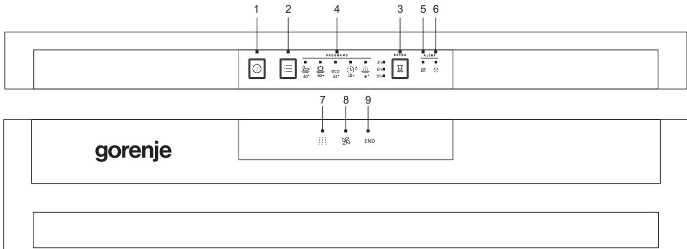
1. Interrupteur Marche/Arret: pour allumer/eteindre l'appareil.
