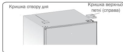
2. За допомогою торцевого або ріжкового ключа 8 мм викрутіть спеціальні саморізи з фланцем, які кріплять праву верхню петлю (підтримуйте верхні дверцята рукою під час цього).
