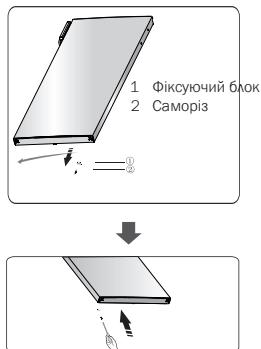
6. Покладіть прилад на м'яке упакування з пінопласту або аналогічного матеріалу. Зніміть обидві регульовані ніжки, а також від'єднайте нижню петлю, викрутивши спеціальні гвинти з фланцем.
