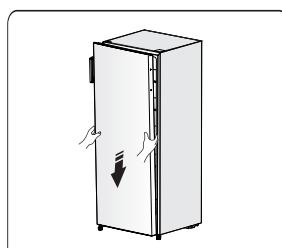
9. Перемістіть верхню петлю та вставте її вісь у верхній отвір дверцят. Відрегулюйте положення дверцят (підтримуйте дверцята рукою під час цього), закріпивши верхню петлю спеціальними гвинтами з фланцем.
