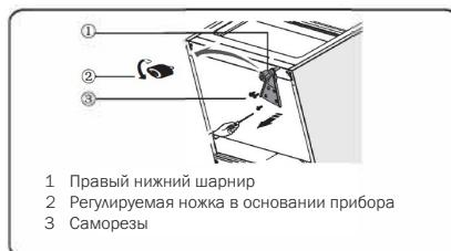
6. Переставьте нижний шарнир на левую сторону и прикрутите саморезами с фланцем. Поменяйте местами регулируемые ножки и закрепите.
