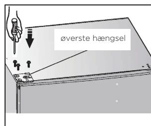
10. Monter dækslet over skruehullerne øverst på højre side af apparatet. Monter dækslet til det øverste hængsel (medfølger i plastposen) øverst på venstre side af apparatet. Læg det andet dæksel i plastposen.
