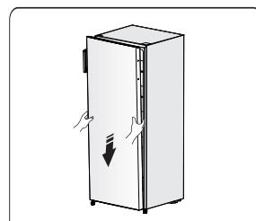
9. Flyt det øverste hængsel til den modsatte side end før. Sørg for, at stiften på det øverste hængsel går ind i det øverste hul på den øverste dør, og tilpas den øverste dørs position, men du understøtter den med hånden. Skru det øverste beslag fast med selvskærende skruer.
