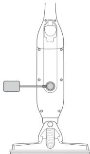
Fastgør ladeadapteren med netledningen til støvsugerens bagside. Adapteren/opladeren har en magnetisk indsats, så den er lettere at tilslutte, hvilket gør opladningen nemmere.
