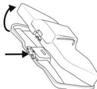
Po zdjęciu pojemnika na kurz ze szczotki należy nacisnąć przycisk, aby otworzyć pojemnik na kurz i opróżnić go.
