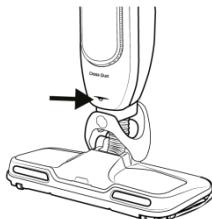
Pentru a pulveriza apă pe pardoseală, apăsați butonul de pe partea din spate a mânerului. Aparatul pulverizează apa printr-o duză situată pe partea din față, deasupra periei.
