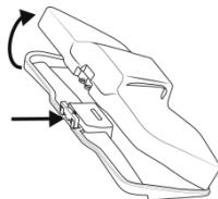
Poista pölysäiliö imurista, paina avauspainiketta ja tyhjennä säiliö. Pölysäiliö voidaan pestä vedellä, mutta sen täytyy antaa kuivua täysin ennen kiinnittämistä uudelleen laitteeseen.
