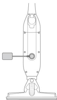
Collegare l'adattatore di ricarica con il cavo di alimentazione sul retro dell'aspirapolvere. L'adattatore/caricatore ha un inserto magnetico per facilitare il collegamento e la ricarica.
