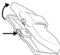
När du tar bort dammbehållaren från borsten trycker du på knappen för att öppna dammbehållaren och tömma den.
