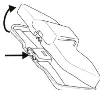
Amikor eltávolította a portartályt a keféből, nyomja meg a gombot a portartály kinyitásához és kiürítéséhez.
