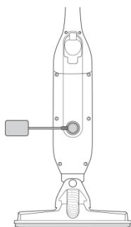
Nabíjací adaptér s napájacím káblom pripojte k zadnej strane vysávača. Adaptér/nabijačka má magnetickú vložku na jednoduchšie pripojenie a nabíjanie.
