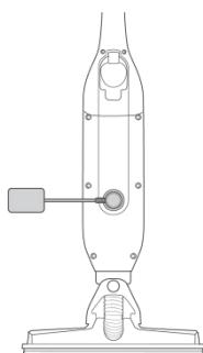
Nabíjecí adaptér s napájecím kabelem připojte k zadní straně vysavače. Adaptér/nabíječka má magnetickou vložku pro snadnější připojení a nabíjení.
