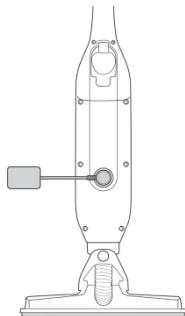
Pričvrstite adapter za punjenje s kabelom napajanja na stražnju stranu usisavača. Adapter/punjač ima magnetski umetak za lakše povezivanje i punjenje.
