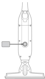
Conekte o adaptador de carregamento com o cabo de alimentação na parte de trás do aspirador. O adaptador/carregador tem um elemento magnético para facilitar a conexão e o carregamento.
