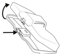
Ko odstranite posodo za prah s krtače, s pritiskom na gumb odprite posodo za prah in jo izpraznite.
