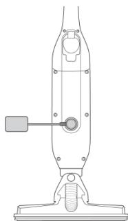
Csatlakoztassa a töltőadaptert a tápkábellel a porszívó hátsó részéhez. Az adapter/töltő mágneses betéttel rendelkezik a könnyebb csatlakoztatás és töltés érdekében
