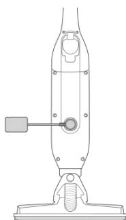
Przymocuj adapter do ładowania z przewodem zasilającym do tylnej strony odkurzacza. Adapter/ladowarka posiada wkładkę magnetyczną ułatwiającą podłączenie i ładowanie.
