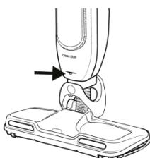
Aby rozpylić wodę na podłogę, naciśnij przycisk znajdujący się z tyłu uchwytu. Urządzenie rozpyla wodę przez dyszę znajdująca się z przodu, nad szczotką.
