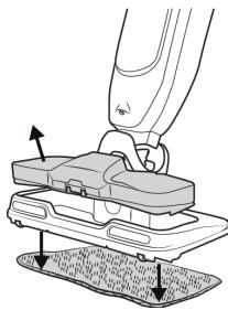
Odstaňte také mopovací podložku připevněnou ke spodní části kartáče pomocí suchého zipu. Podložku lze znova použít a lze ji práť v pračce do 40 °C. Nedoporučujeme sušení v sušičce, protože nadměrná teplota může způsobit deformaci.
