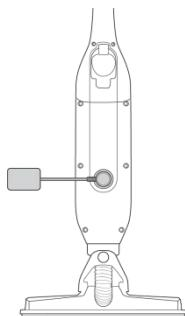
Conecte el adaptador de carga con el cable de alimentación a la parte posterior de la aspiradora. El adaptador/cargador tiene un imán para facilitar la conexión y la carga.
