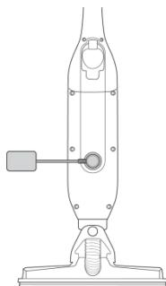
Fest ladeadapteren med strømledningen til baksiden av støvsuger'en. Adapteren/laderen er magnetisk for å gjøre den enklere å koble til og lade.
