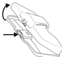
Når du fjerner støvbeholderen fra børsten, skal du trykke på knappen for at åbne støvbeholderen og tömme den.
