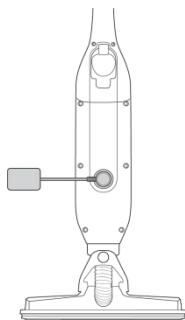
Priklučite adapter za punjenje sa kablom za napajanje na zadnju stranu usisivača. Adapter/punjač ima magnetni umetak za lakše povezivanje i punjenje.
