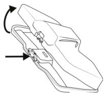
Quando remover o depósito de pó da escova, pressione o botão para abrir o depósito de pó e esvazíá-lo. O depósito pode ser lavado, mas deve ser completamente seco antes de ser colocado novamente no lugar.
