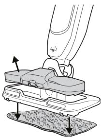
Контейнер для пыли расположен в верхней части щетки. Чтобы снять контейнер, возьмитесь за приподнятую часть в центре и потяните вверх.
