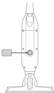
Під'єднайте кабель блока заряджання до розніму на задній стороні пилососа. Зарядний пристрій має магнітну вставку для полегшення підключення та заряджання.
