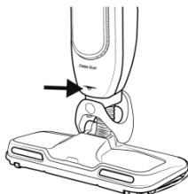
Per spruzzare acqua sul pavimento, premere il pulsante sul lato posteriore del manico. L'elettrodomestico spruzza acqua attraverso un ugello sul lato anteriore, sopra la spazzola.
