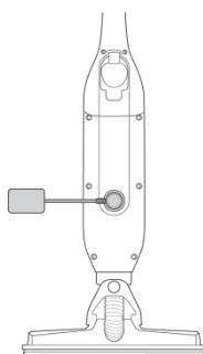
Зарядтау адаптерін қорек шнурының көмегімен шаңсорғыштың артқы бетіне жалғаңыз. Адаптердің/зарядтау құрылғысының айтарлықтай женіл қосылуға және зарядтауға арналған магнитті қондырмасы бар.
