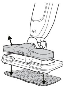
Der Staubbehälter befindet sich auf dem oberen Teil der Bürste. Um den Staubbehälter zu entfernen, greifen Sie den erhöhten Mittelteil und heben Sie ihn einfach an.
