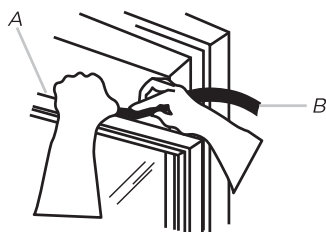
A A felső ablakszárny teteje B Tömítőszalag
