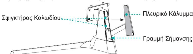
2. Αφού ολοκληρώσετε την εγκατάσταση του Καλωδίου τροφοδοσίας, τοποθετήστε ξανά το Πλευρικό κάλυμμα στη βάση της στήλης.
