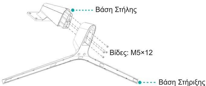
3. Συνδέστε τη βασική κατασκευή στην τηλεόραση με ασφάλεια μέσα στο εξάρτημα με τις 4 βίδες.
