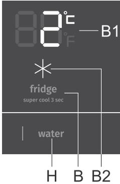
**Einschalten:** Einschalten des Intensivkühlmodus durch langes Drücken (3 Sekunden) der **B**-Taste. Auf dem Display erscheint **B2** und gibt den Wert **2 °C** an.
