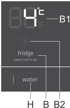
Die Temperatur im **Kühlfach** ist einstellbar mit der **B**-Taste. Drücken Sie die **B**-Taste, bis die **B1** Anzeige die gewünschte Temperatur anzeigt.
