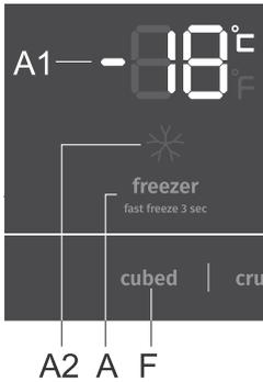
Die Temperatur im **Gefrierfach** ist einstellbar mit der **A**-Taste. Drücken Sie die **A**-Taste, bis die **A1** Anzeige die gewünschte Temperatur anzeigt.
