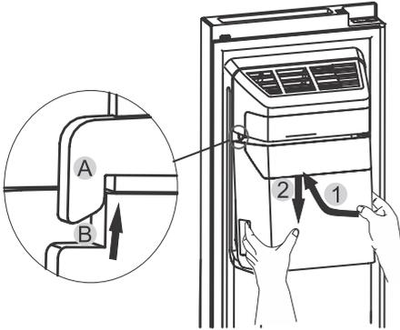
1. Schieben Sie den Eiskübel nach oben und stellen Sie sicher, dass die beiden seitlichen Nuten (B1 und B2) am Eiskübel in den Kupplungen (A1 und A2) einrasten.
