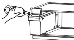
Heben Sie die kleine Kappe auf der Vorderseite an und gießen Sie dann Wasser direkt in den Vorratsbehälter.
