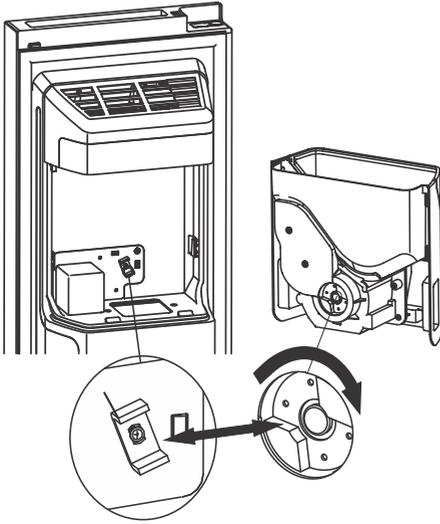
Bevor Sie den Eiskübel wieder einbauen, überprüfen Sie bitte, ob die Koppler im richtigen Winkel zueinander passen. Wenn nicht, bewegen Sie den Eiskübelkoppler in einen solchen Winkel, dass er mit dem Motorkoppler übereinstimmt.
