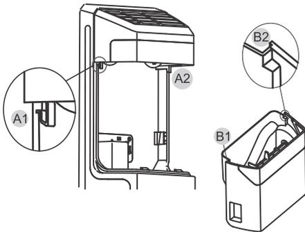
Wenn Sie den Eiskübel wieder einsetzen, stellen Sie sicher, dass die beiden Seitennuten (A1 und B1) am Eiskübel in den Kupplungen (A1 und A2) einrasten.
