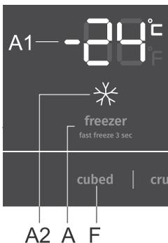
**Einschalten:** Einschalten des Intensivgefriermodus durch langes Drücken (3 Sekunden) der **A**-Taste. Auf dem Display erscheint **A2** und gibt den Wert **-24 °C** an.
