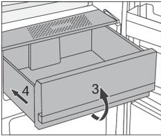
Setzen Sie das Fach in umgekehrter Reihenfolge wieder ein (3 und 4).
