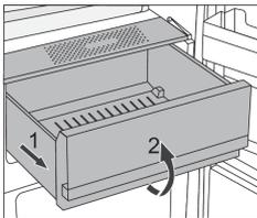
Ziehen Sie das Fach bis zum Anschlag (1) heraus, heben Sie es vorne etwas an (2), dann können Sie es vollständig herausziehen.
