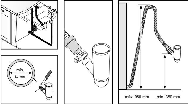
El tubo de desagüe se puede extender un máximo de 3 m (la longitud total del tubo no puede ser superior a 4,5 m en ningún caso). Todos los empalmes y tubos de conexión deben tener un diámetro interno de 14 mm como mínimo.
