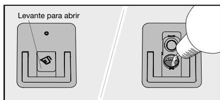
Si ha activado el ajuste Dosificación automática de detergente, llene el depósito de dosificación automática con detergente lavavajillas en gel.
