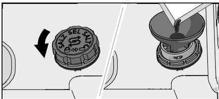
Si el agua utilizada tiene una dureza superior a 5 °dH (9 °fH / 6 °eH / 0,9 mmol/l), rellenar con sal.
