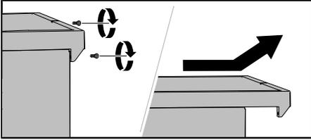
El lavavajillas se puede instalar en un espacio sin su cubierta. Si se retira la cubierta del lavavajillas, el lavavajillas se debe instalar de forma que quede cerrado por ambos lados y se encuentre debajo de una encimera separada. Si el lavavajillas se instala de forma que uno de los lados sea visible, es necesario colocar un accesorio de sujeción en el borde posterior del lavavajillas. Los accesorios se pueden adquirir en el mismo punto de venta que el lavavajillas.
