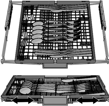
La bandeja superior para cubiertos se compone de tres partes que se pueden mover hacia los lados para acomodar mejor los platos.
