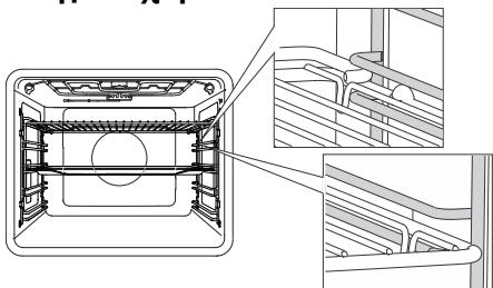
Για τους οδηγούς σχάρας, τοποθετείτε πάντα τη σχάρα και τα ταψιά μέσα στην υποδοχή μεταξύ του πάνω και του κάτω τμήματος κάθε οδηγού.
