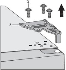
Lösen Sie die Schrauben (2) und entfernen Sie das Scharnier (3). Halten Sie die Tür dabei fest, damit sie nicht herunterfällt.
