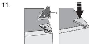
Entfernen Sie die obere Scharnierabdeckung (1).
