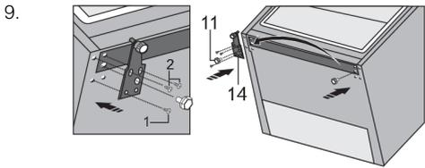
Befestigen Sie das Scharnier (14) mit den Schrauben auf der gegenüberliegenden Seite. Die Schrauben sollten in der in der Abbildung unten gezeigten Reihenfolge angebracht werden. Zuerst Schraube 1 festziehen, dann Schrauben 2. Dann die Stellfüße (11) anschrauben.
