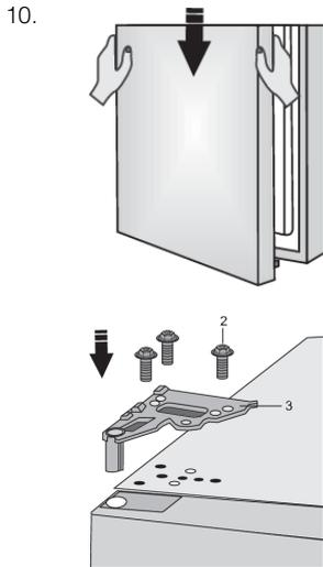
Legen Sie die Tür auf das untere Scharnier und verwenden Sie die Schrauben (2) zum Anbringen des oberen Scharniers (3). Halten Sie die Tür fest, während Sie sie in Position bringen.
