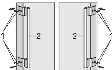
Lösen Sie die Schrauben (1) wie in der Abbildung dargestellt. Drehen Sie den Griff (2) um 180° und ersetzen Sie ihn auf der gegenüberliegenden Seite. Dann ziehen Sie die Schrauben fest (1).
