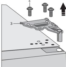
Lösen Sie die Schrauben (2) und entfernen Sie das Scharnier (3). Halten Sie die Tür dabei fest, damit sie nicht herunterfällt.
