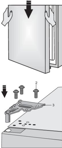
Legen Sie die Tür auf das untere Scharnier und verwenden Sie die Schrauben (2) zum Anbringen des oberen Scharniers (3). Halten Sie die Tür fest, während Sie sie in Position bringen.
