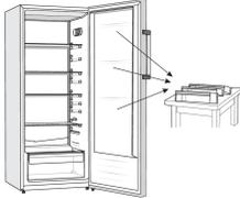
Stellen Sie das Gerät in eine aufrechte Position. Öffnen Sie die Tür und entfernen Sie die Türablagen (um sie während des Verfahrens nicht zu beschädigen). Schließen Sie dann die Tür.
