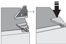
Entfernen Sie die obere Scharnierabdeckung (1).
