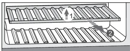
El botellero con fondo de madera está diseñado para almacenar las botellas en la zona del compresor. Esta zona es idónea para almacenar botellas que desea conservar durante un periodo más prolongado, especialmente para una maduración sin vibraciones excesivas ni movimientos innecesarios. Para retirar la rejilla inferior del aparato, levántela (1) y sáquela (2). Procure no dañar la junta de la puerta.
