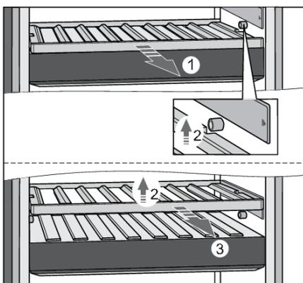
Para retirar un estante del aparato, tire de él parcialmente hacia usted (1) hasta que las dos ranuras del estante y los dos bloques (izquierdo, derecho) de la celda estén alineados. A continuación, levante el estante (2) y extráigalo del aparato (3). Procure no dañar la junta de la puerta.
