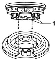
Utilice las guías (1) para montar las piezas del fogón.
