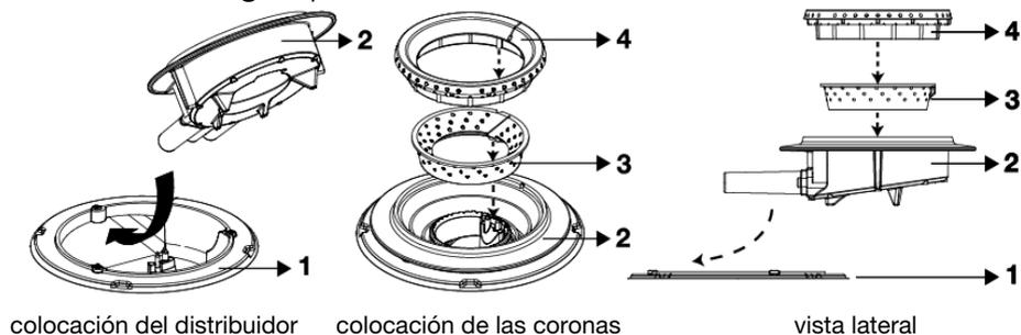
Coloque el fogón para wok de la manera correcta. Una colocación incorrecta de las piezas del fogón especial para woks puede dar lugar a un mal funcionamiento del fogón.
