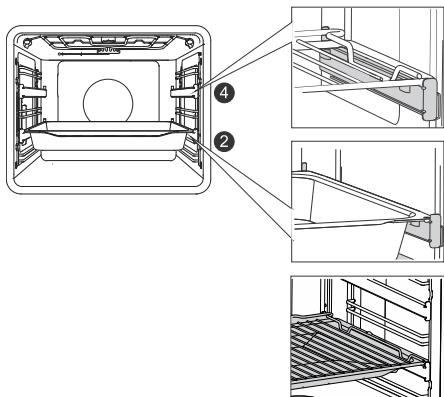
Може да се вградат водилки на извлекување за второто и четвртото ниво.
