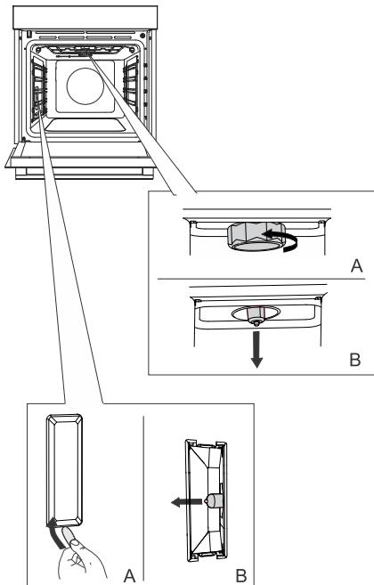
**1** Открутите (против часовой стрелки) и снимите крышку. Извлеките галогенную лампочку.
