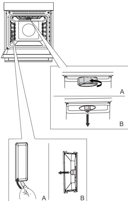
**1** Odvijte in odstranite pokrov (v nasprotni smeri urnega kazalca). Izvlecite halogensko žarnico.
