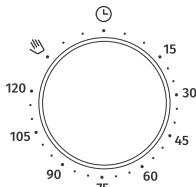
**IZKLOPNI MINUTNIK** (časovno stikalo): Najprej nastavite sistem in temperaturo pečenja. Čas nastavite z vrtenjem gumba v smeri urnega kazalca. Po izteku nastavljenega časa se izbrani sistem izklopi.
