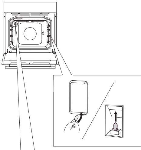
С помощью отвертки подденьте и снимите крышку. Замените лампочку.
