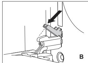
**B** Откиньте фиксаторы назад на 90° (при плавном закрывании дверцы, рис. 2).
