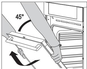
**3** Повільно зачиніть дверцята та залиште в положенні під кутом 45 градусів (відносно до положення повністю зачинених дверцят), а потім підніміть їх і повністю вийміть.
