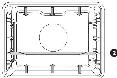
Нагрівачі в нижній і верхній частині духовки рівномірно випромінюють тепло в її внутрішню камеру.
