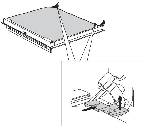
**1** Трохи підніміть кріплення ліворуч і праворуч від дверцят (позначка 1 на кріпленні) і витягніть їх зі скляної панелі (позначка 2 на кріпленні).
