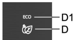
**Colocação em funcionamento:** para ativar a função **Eco**, prima rapidamente a tecla **D**. O ícone **D1** fica ligado. Quando esta função estiver ativa, o aparelho funciona com ótimos ajustes.
