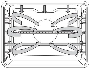
En el modo de Asado automático, el calentador superior se acciona en combinación con el calentador del grill y el calentador circular. Se utiliza para asar todo tipo de carnes.
