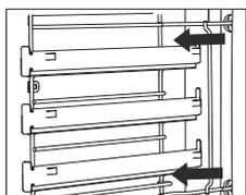
**2** Extraiga las guías de los orificios de la pared trasera.
