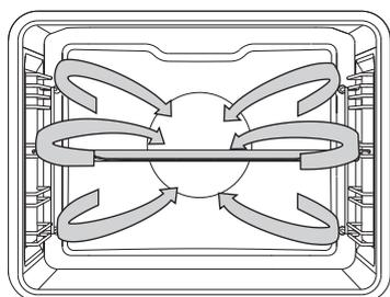
El calentador redondo y el ventilador funcionarán. El ventilador instalado en la pared trasera de la cavidad del horno asegura que el aire caliente circule constantemente alrededor de la carne, las verduras o los pasteles.
