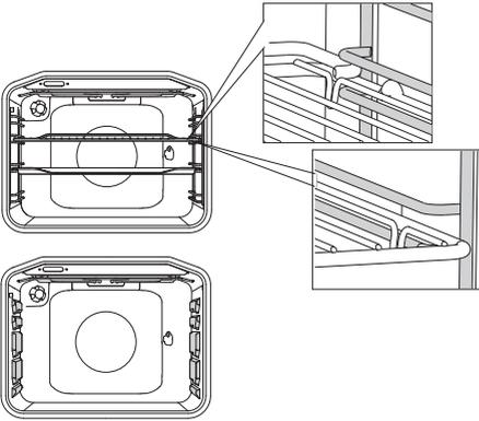
Con guías extensibles telescópicas, primero extraiga las guías de un nivel y coloque la parrilla o la bandeja de horneado sobre ellas. A continuación, empújelas con la mano hasta el final de su recorrido.
