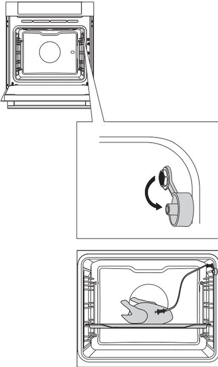
**1** Retire el tapón (el conector se encuentra en la esquina superior delantera de la pared derecha).
