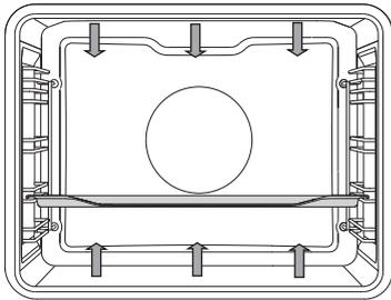
Los calentadores situados en la bóveda y la solera del horno irradian calor de forma uniforme en el interior del horno.
