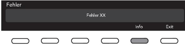
Durch Drücken der Taste INFO wird auf dem Display die Beschreibung des Fehlers angezeigt.
