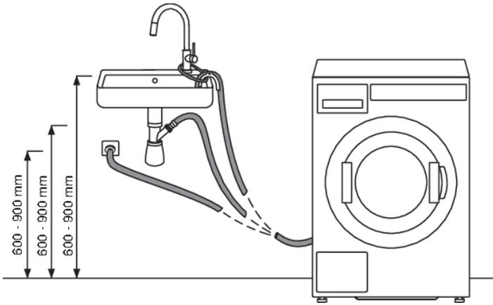
Sie können den Ablaufschlauch auch direkt an den Siphon des Waschbeckens anschließen. In diesem Fall muss der Durchmesser des Schlauchs 600–900 mm über dem Boden montiert sein. Der Innendurchmesser des Schlauchs muss mindestens 18 mm betragen
