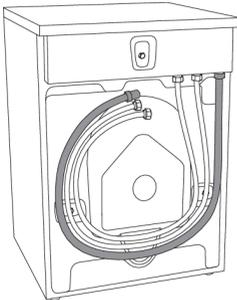
Die Waschmaschine ist mit einem Ablaufschlauch ausgerüstet, der an den Abfluss anzuschließen ist. Sie können den Ablaufschlauch auch in den Wandsiphon montieren, jedoch muss dies fachgerecht gemacht werden, damit er später gereinigt werden kann. Der Ablaufschlauch muss 600-900 mm über dem Boden montiert werden. Wir empfehlen die untere Position (600 mm). Sorgen Sie dafür, dass der Ablaufschlauch nicht geknickt ist.
