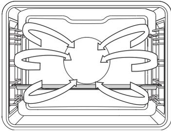
L'acqua dal generatore di vapore entra nel vano di cottura in forma di vapore. In aggiunta, il riscaldatore rotondo con ventola assicura la circolazione continua dell'aria calda e del vapore.
