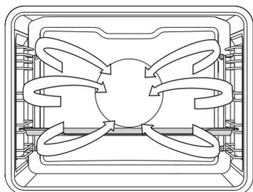
L'acqua dal generatore di vapore entra nel vano di cottura in forma di vapore.
