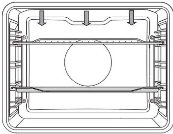
Nel grande grill funzionano il riscaldamento superiore e quello a raggi infrarossi che sono installati nella parte superiore del forno.
