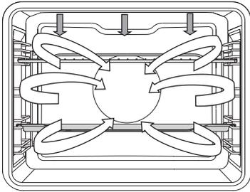
Con questo sistema funzionano simultaneamente il riscaldamento a raggi infrarossi e la ventola. È adatto per la cottura di carne, pesce, verdure.
