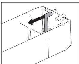
**2** Rimuovi il tubo di aspirazione dall'attacco del tubo.
