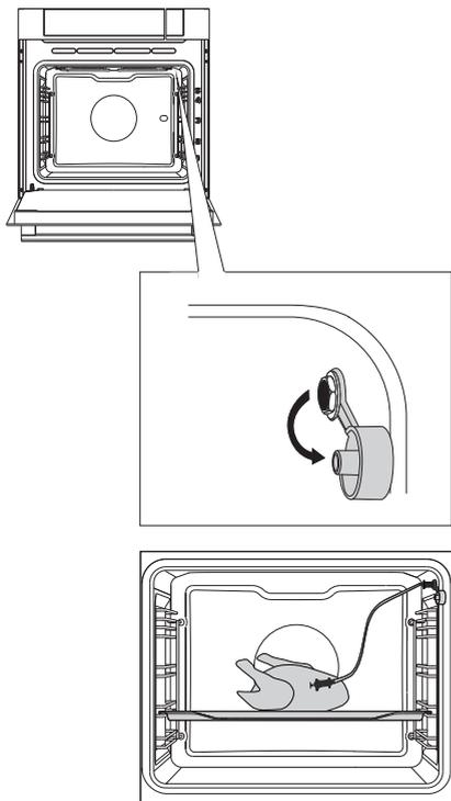
**1** Rimuovi il tappo (la presa si trova nell'angolo anteriore superiore della parete di destra del forno).
