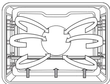
Si usa per la cottura di dolci a bassa lievitazione e per fare le conserve di frutta e verdura. Si usa il 2° livello da sotto e una forma da dolci non troppo alta in modo che l'aria riscaldata circoli anche sul lato superiore del cibo che sta cuocendo.
