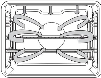
Durante la cottura automatica funziona il riscaldamento superiore in combinazione con quello a raggi infrarossi e con il riscaldamento circolare. Si usa per tutti i tipi di carne.
