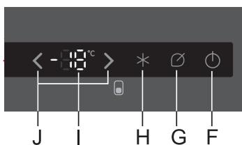
**Izklop aparata:** Aparat izklopite z daljšim pritiskom (3 sekunde) tipke **F** (pozor: aparat je še vedno pod električno napetostjo).
